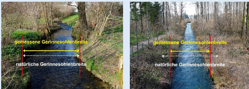
Bestimmen der natürlichen Gerinnesohlenbreite; Bildquelle: eigene Aufnahmen von Fließgewässern in Burgdorf (BE)
